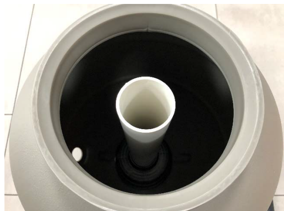
Abb. Innenverrohrung stehend (mittig) im Filterkessel
